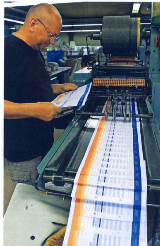
Alfred Felger kontrolliert das erste Blatt des Wiegenscheins. Die Durchschläge folgen. Auf dieser Maschine wird am Ende das Rollenpapier zu Bögen geschnitten.
