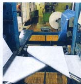
Die Rückseite ist bedruckt, am Wendekreuz wird die Papierbahn umgedreht.
