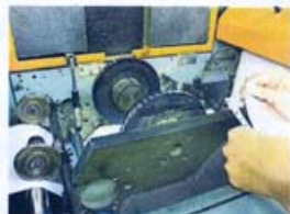
Perforations- und Stanzwerkzeug in der Endlosformulardruckmaschine. Fotos: Friedrich
